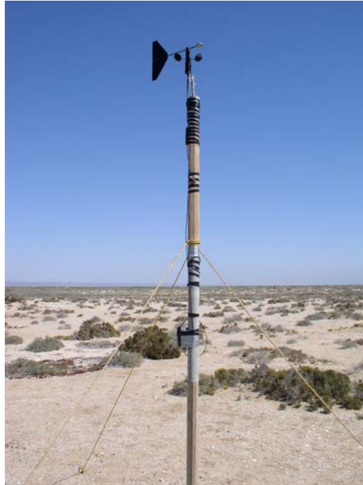
Figura 2. Estación meteorológica HOBO midiendo dirección y velocidad del viento en Punta Piedra
