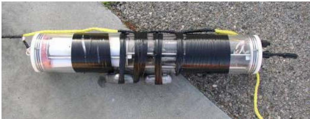
Figura 1. Grabadora acústica autónoma (con hidrófono) unido a la línea de colocación.
